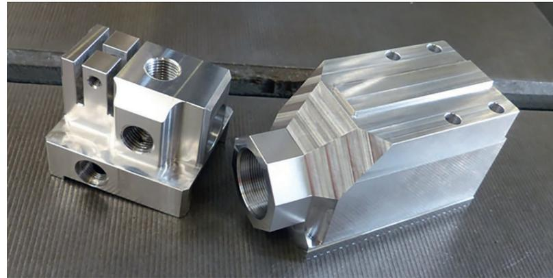
4 Die meisten Bauteile bei Stöger bestehen so wie diese aus hochfestem Aluminium 7075 AlZnMgCu. Der OSG-Fräser ist so leistungsfähig, dass bei der Bearbeitung nicht mehr zwischen Schruppen und Schlichten unterschieden wird © OSG
